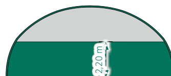
Geschlossener Giebel mit Windschutznetz
