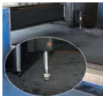
Entsprechend der erstellten CAD-Zeichnung werden die Schlitze mit innovativer Wasserstrahl-Schneidetechnologie passgenau in die Matten geschnitten.
