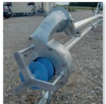
Unteneinlaufpumpe mit robuster Einzugsschnecke
