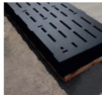
Entsprechend der erstellten CAD-Zeichnung werden die Schlitze mit innovativer Wasserstrahl-Schneidetechnologie passgenau in die Matten geschnitten.
