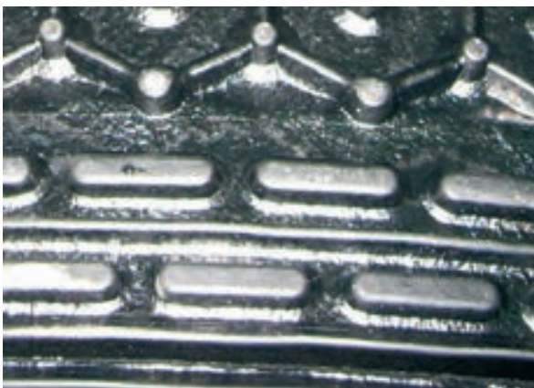
Dichtlippen am Rand bei jeder KKM Ausführung
