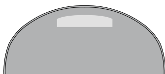
Geschlossener Giebel mit Lüftungsöffnung
