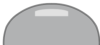
Geschlossener Giebel mit Lüftungsöffnung
