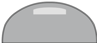
Geschlossener Giebel mit Lüftungsöffnung
